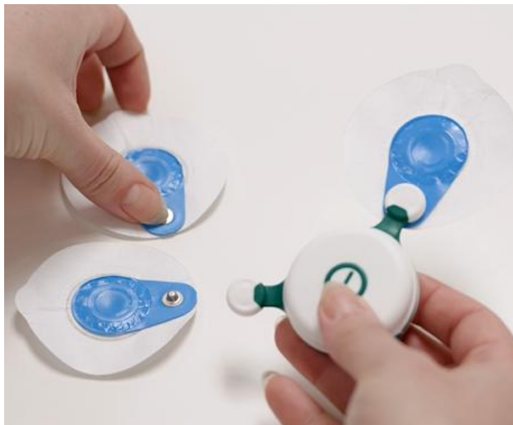
Figur 2: EKG-måleren festes til tre elektroder ved hjelp av trykknapper [2]
